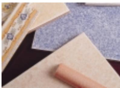
Per quanto concerne le dimensioni, si va dal “mosaico” (piastrelle con superficie di area inferiore a  $90 \text{ cm}^2$ ) a vere e proprie lastre di lato 60 cm o anche superiore. Lo spessore varia da pochi millimetri a oltre  $2 \div 2.5 \text{ cm}$ .
